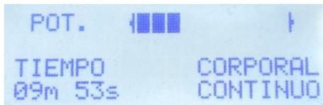
En el modo de trabajo Continuo, la potencia se muestra en la parte superior del visor y se puede ajustar mediante los botones correspondientes. Para incrementar la intensidad, se utiliza la flecha hacia arriba, mientras que, para reducirla, se emplea la flecha hacia abajo. El tiempo se irá descontando automáticamente.
