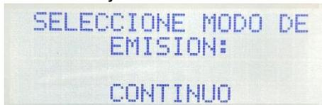
A continuación, debe seleccionar el modo de trabajo: Continuo o Intermitente. Para cambiar, deberá utilizar los botones que indican **Arriba** o **Abajo**. Para confirmar, seleccione el botón de **Inicio**.
