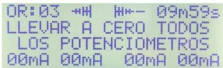
En caso de que los potenciómetros no estén en 0, la pantalla mostrará un mensaje pidiendo que se ajusten todos a esa posición.
