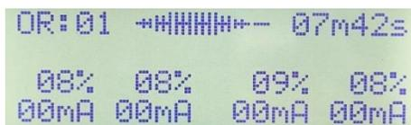
El código OR significa Ondas Rusas, seguido del número del programa en uso. La imagen siguiente muestra la fase actual del proceso, ya sea rampa de subida, contracción, rampa de bajada o relajación. Además, se visualiza el tiempo restante de la sesión, que irá disminuyendo durante el proceso.
