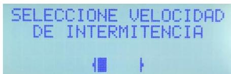
A continuación, debe seleccionar la velocidad de intermitencia. Al presionar el botón **Arriba**, puede pasar al siguiente programa, y al presionar el botón **Abajo**, puede retroceder.
