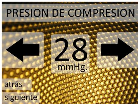
En esta pantalla, puede ajustar la presión que el equipo aplicará sobre la extremidad, inflando cada segmento de la bota de forma controlada. Durante el funcionamiento, una vez que la presión en un segmento alcanza el valor configurado, el equipo detiene el inflado y mantiene la compresión hasta que se cumpla el tiempo establecido en la siguiente pantalla.
