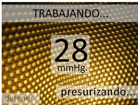
En esta pantalla se indica que el equipo está iniciando el régimen de presurización. Durante este proceso, el equipo infla las botas hasta alcanzar una presión de 15 mmHg. Una vez logrado este valor, realiza una descompresión previa antes de comenzar con el programa configurado
