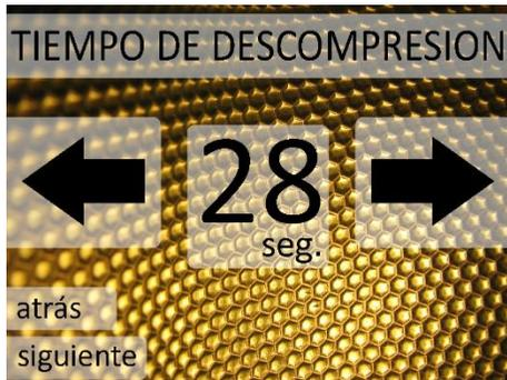
En esta pantalla, puede configurar el tiempo durante el cual el equipo dejará de ejercer presión sobre todos los segmentos. Este tiempo de descompresión se aplica al finalizar el inflado de todos los segmentos y antes de iniciar un nuevo ciclo.
