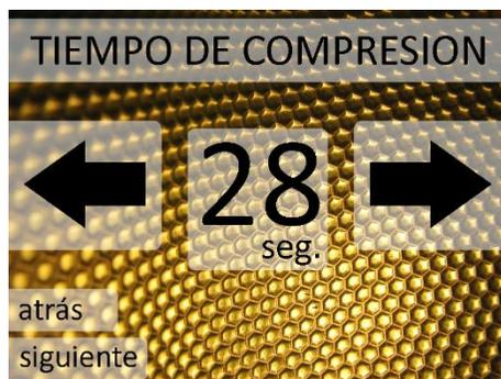
El tiempo de compresión puede ajustarse entre un mínimo de 20 segundos y un máximo de 50 segundos, con incrementos de 5 segundos.
