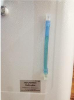
Para garantizar el correcto funcionamiento del equipo y evitar sobrecalentamientos, es fundamental mantener el nivel de líquido refrigerante en condiciones óptimas. Se recomienda revisar el nivel periódicamente y realizar una recarga cuando esté por debajo del **50%**
