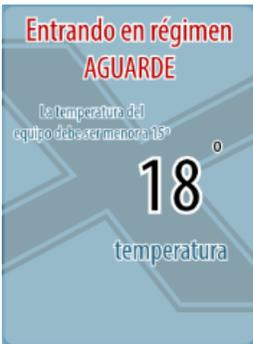
Al encender el equipo, el sistema realiza una lectura automática de la temperatura interna mediante un sensor de temperatura. Este proceso implica que el equipo no iniciará su funcionamiento hasta alcanzar una temperatura de 15 °C. Si al encender el equipo la temperatura no llega a este valor, deberá esperar a que alcance los 15 °C para poder comenzar a trabajar.
