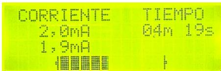
La Corriente indica el nivel de corriente establecido, y este nivel se puede ajustar a través de los botones.
